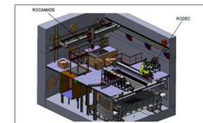
PRÉPARATION DES ATELIERS DE DÉCOUPE DES INTERNES DE CUVE
